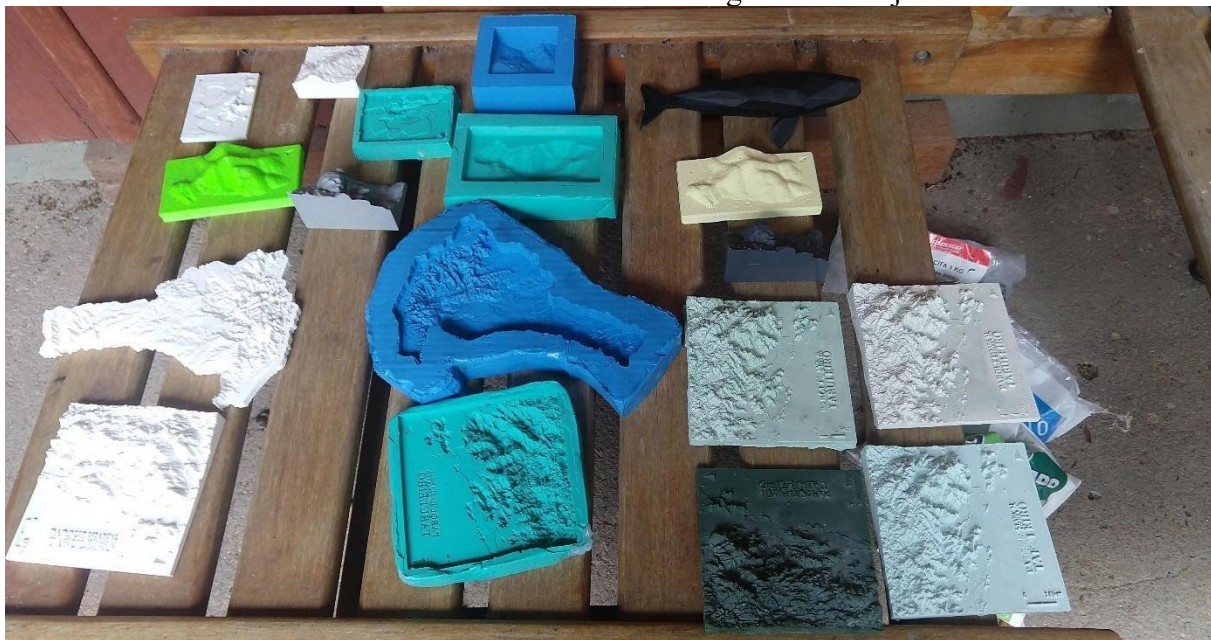
Figura 3 - Da esquerda para direita: Impressões em 3D, moldes de borracha silicone e cópias em resina de artesanato e mistura de gesso com rejunte.
